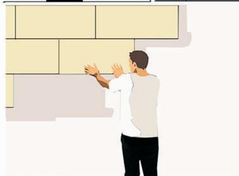
Colocar las planchas una a una presionando y encajándolas bien entre ellas para evitar que se vean mínimamente las juntas.
