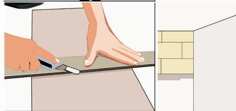
Cortar las planchas que vayan en los extremos de la pared con escuadra y un cúter siempre bien afilado. También se puede usar una máquina de cortar a escuadra de carpintero. (sierra de disco) Es muy importante que el corte sea recto y encaje perfecto con los extremos de la pared, si se quiere que el aspecto visual del decorativo sea óptimo.
