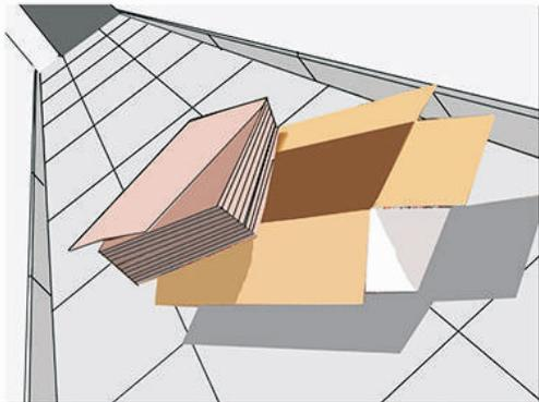
Al ser un producto natural, es aconsejable dejar reposar el corcho sin el envoltorio de plástico o cartón entre 24 y 48 horas antes de su colocación, para aclimatarlo al grado de humedad ambiental del lugar donde se instale. De esta forma, se evita que el material tenga movimientos una vez instalado.
