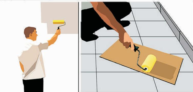
Extender una capa de cola de contacto con un rodillo o pincel en la pared donde se vaya a colocar el producto cubriendo aproximadamente la superficie de 1 metro cuadrado. Después aplicar de la misma forma la cola en el reverso de las planchas de corcho. Encolar un número de planchas adecuado para cubrir el metro cuadrado de cola que hay extendido en la pared.
