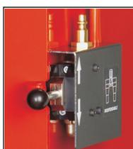
Valvular monomando. Sistema de seguridad que impide el accionamiento de la válvula. Si la puerta no está bien cerrada.
