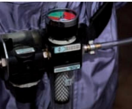
Equipo de respiración que incorpora: careta, cinturón, filtro de carbón activo, regulador prefijado, 10 m. de manguera + enchufes de seguridad, 1,5 m. de manguera y salida para pistola.
