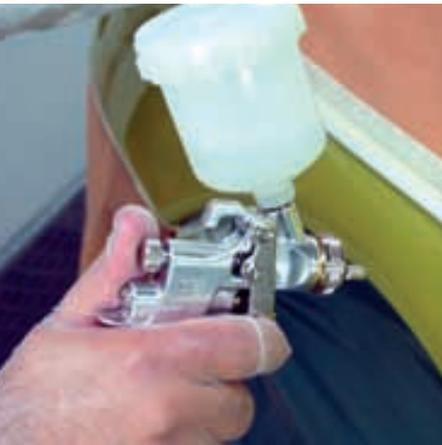
Pistola aerográfica de gravedad que, por sus reducidas dimensiones, es ideal para realizar difuminados, pequeños retoques y/o pintado de pequeñas piezas. Incorpora depósito de 125 cc., de alta calidad y filtro de pintura.
